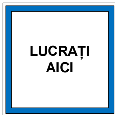
Figura 12.a) Indicatorul de securitate „LUCRAȚI AICI” Figura 12.b) Indicatorul de securitate „URCAȚI AICI”
