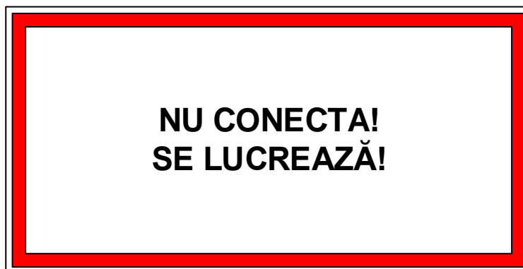
Figura 1. Indicatorul de securitate „NU CONECTA! SE LUCREAZĂ”
