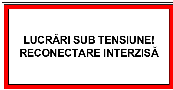
Figura 4. Indicatorul de securitate „LUCRĂRI SUB TENSIUNE! RECONECTARE INTERZISĂ”
